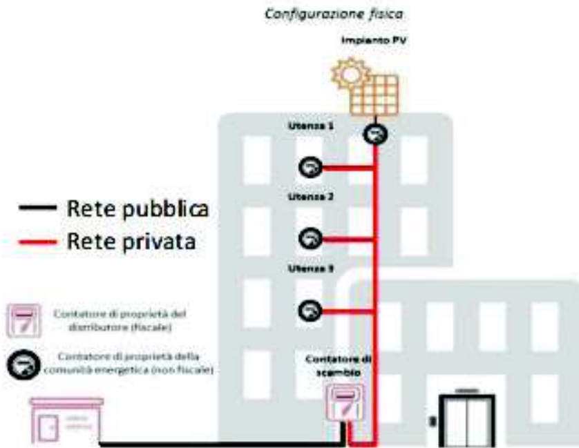
Figura 2 – Schema di autoconsumo fisico con connessione privata delle utenze all'impianto di produzione
