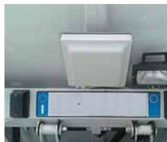
*Antenna montato su un mezzo di raccolta rifiuti per la lettura di transponder (RFID)*
